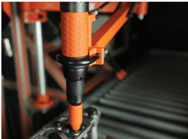
Das Werkzeugkabel des NeoTek besitzt die erste Viertelumdrehungs-Verriegelung in der Branche und beseitigt damit eine der häufigsten Ursachen für Schäden am Werkzeugkabel: beschädigte Gewinde. Dank digitaler Kommunikation zwischen Werkzeug und Steuerung hat das Werkzeugkabel statt 28 nur noch 8 Adern, was einen deutlich geringeren Kabeldurchmesser und eine Gewichtseinsparung von 50% ermöglicht.
