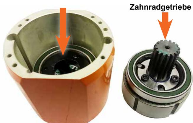
5. Montieren Sie die acht (8) O-Ringe (1010216) in die Senklöcher an der Vorderseite des Getriebegehäuses. Montieren Sie den Stift (634339PT) in die Vorderseite des Getriebegehäuses wie gezeigt.
