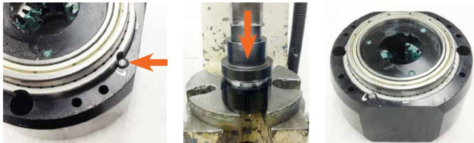
9. Installieren Sie den Inline-Antriebsadapter auf der Baugruppe Planetengehäuse. Richten Sie die Stiftkerbungen im Inline-Antriebsadapter mit den Stiften im Getriebekorb aus. Verwenden Sie eine Dornpresse, um die Montage des Inline-Antriebsadapters abzuschließen. Montieren Sie mit einem 2,5 mm Inbusschlüssel die Schraube (634345PT), um den Inline-Antriebsadapter zu sichern.
