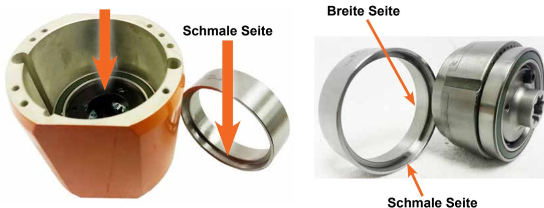
4. Fügen Sie die Baugruppe oberer Getriebekorb mit dem Zahnradgetriebe zuerst in das Getriebegehäuse und auf das Getriebedistanzstück ein. Das Zahnradgetriebe muss vollständig in die Baugruppe unterer Getriebekorb eingreifen.
