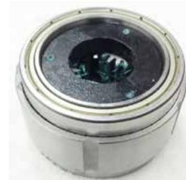
7. Installieren Sie einen Passstift (634339PT) im Planetengehäuse (634575PT). Nutzen Sie eine Dornpresse, um den Passstift vollständig in das Planetengehäuse einzubringen.
