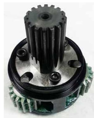
3. Installieren Sie ein Kugellager (93450775) auf der Unterseite der Baugruppe Getriebekorb. Tragen Sie Getriebefett auf die Baugruppe Getriebekorb auf und montieren Sie sie in den Zahnkranz (90515063PT). **WICHTIG: STELLEN SIE SICHER, DASS DER LAGERSITZ IN DEN ZAHNRADZÄHNEN RICHTIG IN DAS KUGELLAGER AUF DER BAUGRUPPE GETRIEBEKORB EINGREIFT.**
