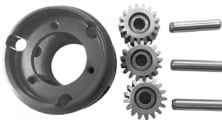
2. Montieren Sie das Zahnradgetriebe in der Kupplung und ziehen Sie es fest. Montieren Sie die Baugruppe Kupplung und Zahnradgetriebe in der Baugruppe oberer Getriebekorb. Stellen Sie für eine korrekte Passung sicher, dass alle Schlitze der Kupplung mit den Stiften der Planetengetriebe ausgerichtet sind. Montieren Sie mit einem 3 mm Inbusschlüssel drei (3) Schrauben (94234135), um die Baugruppe Kupplung am Getriebekorb zu fixieren.
