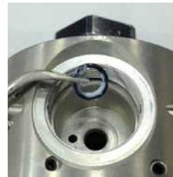
5. Tragen Sie O-Ring-Schmiermittel auf den O-Ring (91815351PT) auf und installieren Sie ihn auf dem Schieber (93815041PT). Installieren Sie den Schieber im Sicherheitsgehäuse. Bringen Sie den Schieber in das Sicherheitsgehäuse ein bis er bündig mit der Oberfläche der Bohrung abschließt.
