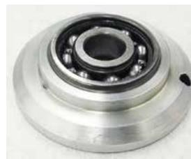
7. Positionieren Sie die Baugruppe vordere Auflagerplatte so, dass die innere Lauffläche frei ist. Messen Sie mit einem Tiefenmikrometer den Abstand von der Front der vorderen Auflagerplatte bis zur inneren Lauffläche des Lagers. Durch diese Messung wird der erforderliche Rotorbund bestimmt. Der Rotorbund sollte folgenden Abstand haben: + 0,002".
