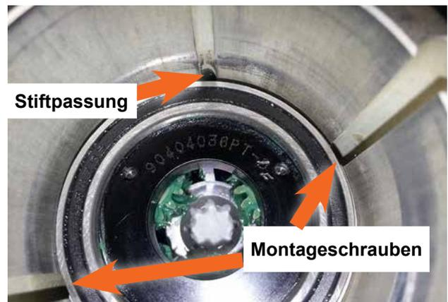
3. Installieren Sie das Getriebedistanzstück (90835939PT) auf die Baugruppe unterer Getriebekorb im Getriebegehäuse. **MONTAGEHINWEIS: DIE SCHMALE SEITE DES DISTANZSTÜCKS MUSS AUF DIE BAUGRUPPE UNTERER GETRIEBEKORB MONTIERT WERDEN.**
