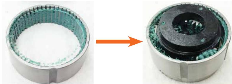
6. Installieren Sie das zweite Kugellager auf dem anderen Ende des Getriebekorbs. Falls notwendig, verwenden Sie eine Dornpresse, um das Lager vollständig auf den Getriebekorb aufzubringen.
