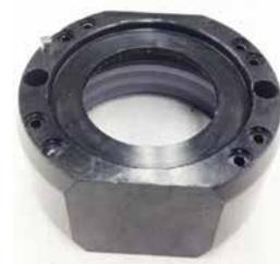
8. Fügen Sie den Getriebekorb in das Planetengehäuse ein. Stellen Sie sicher, dass die Stiftkerbe auf der Außenseite des Zahnrads mit dem vorher im Planetengehäuse installierten Stift (634339PT) ausgerichtet ist (634339PT). Verwenden Sie eine Dornpresse, um die Installation der Baugruppe Getriebekorb im Planetengehäuse abzuschließen.
