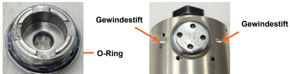
12. Installieren Sie das Tellerventil (531226), die Feder (634645PT) und den Startknopf (642384PT) in der Baugruppe Sicherheitsgehäuse. Halten Sie den Knopf fest und nutzen Sie einen 1,5 mm Inbusschlüssel, um zwei (2) Gewindestifte (94221100) zu installieren und festzuziehen, um den Startknopf zu fixieren. Ziehen Sie die Gewindestifte mit Drehmoment 32 in-lbf (3,66 Nm) fest. Die Gewindestifte müssen in die Nuten an der Seite des Startknopfes passen, damit dieser bewegt werden kann.
