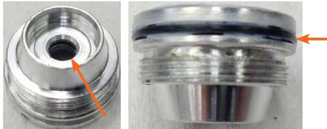
7. Schrauben Sie die Sicherheitsventilführung in das Sicherheitsgehäuse ein. Ziehen Sie die Sicherheitsventilführung mit der Montagevorrichtung (TF-634900) fest.
