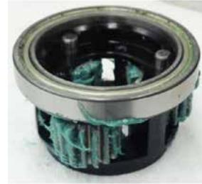
5. Tragen Sie auf die Zähne des Zahnkranzes Accrolube auf. Montieren Sie ihn auf dem Getriebekorb mit dem Ausschnitt der Zahnradzähne vom Kugellager weg zeigend.
