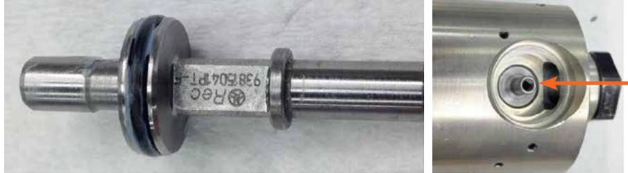
6. Tragen Sie O-Ring-Schmiermittel auf den kleinen O-Ring (91815155) und installieren Sie ihn in den Freistich der Bohrung innerhalb der Sicherheitsventilführung (90225692PT). Tragen Sie O-Ring-Schmiermittel auf den großen O-Ring (91815721PT) auf und montieren Sie ihn in die O-Ring-Nut auf dem Außenradius der Sicherheitsventilführung.
