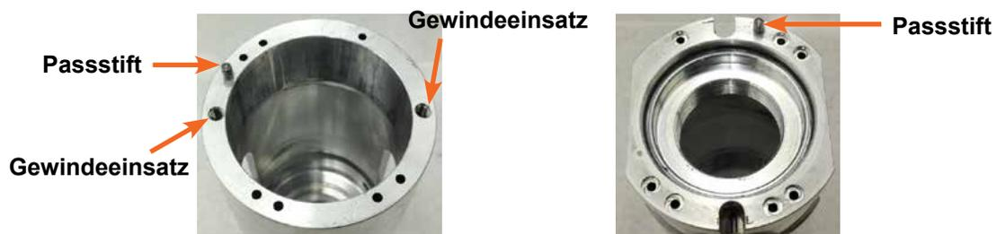
2. Montieren Sie mit einem 2 mm Inbusschlüssel drei (3) Gewindestifte (634669PT) im Motorgehäuse.
