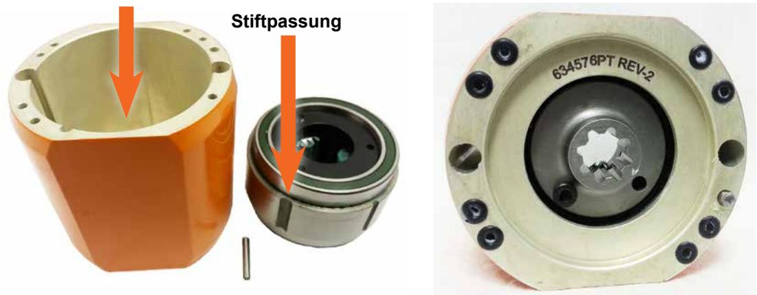
2. Montieren Sie den Passtift (91216105) in die ausgerichtete Stiftpassung des Getriebegehäuses und des Zahnkranzes auf dem unteren Getriebekorb. Die beiden großen Bohrungen im Getriebegehäuse sind für die Montageschrauben des Getriebekopfs gedacht.
