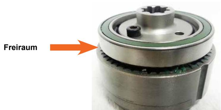
**Montage oberer Getriebekorb** (Die Teilenummern können zwischen den Getriebebaugruppen abweichen, aber der Montageprozess ist derselbe)
