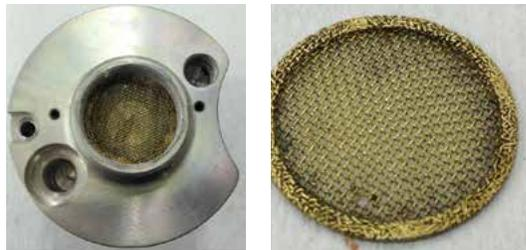
Die gefalteten Kanten müssen zum Inneren des Sicherheitsgehäuses hin zeigen.
